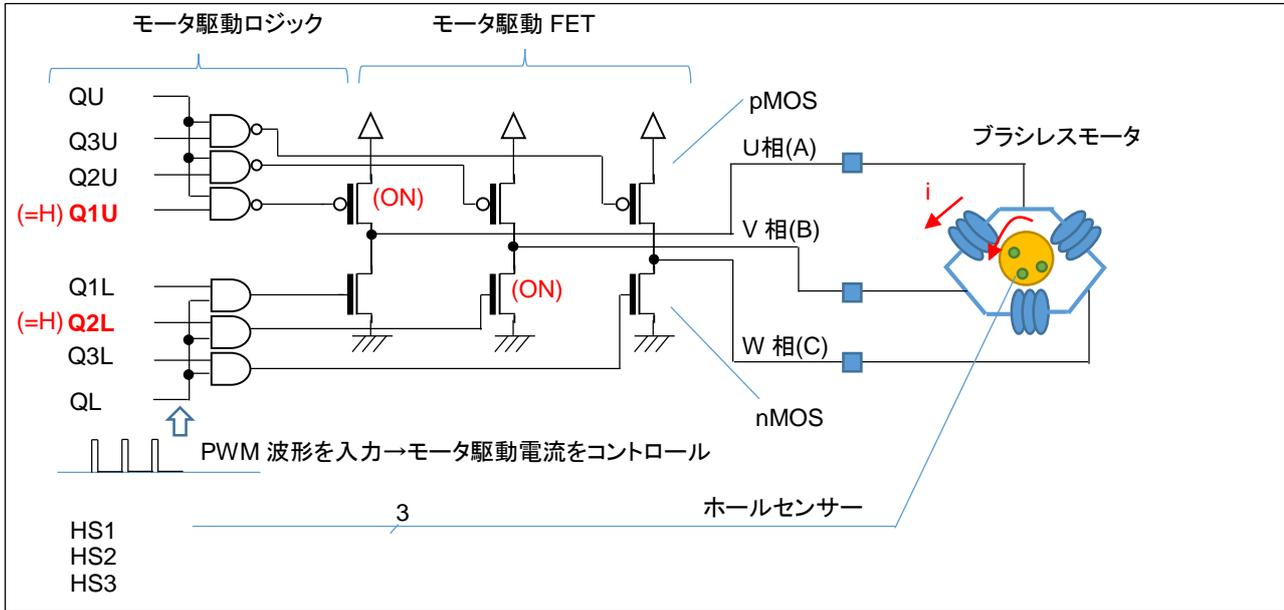
図 3-2 モータ駆動回路
