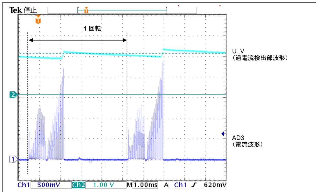
電流は、1回転で U 相に流れ込むタイミングが、V→U, W→U(6条件中2条件)となり、(この波形は PWM 駆動をしているので、AD3 の波形がパルス状になっている)、電流波形のピークホールド及び RC の時定数でゆっくり放電(降下)するようにした波形が、U\_V となる。
