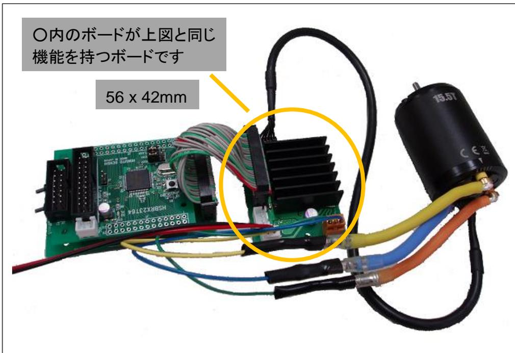
図 1-2 小型モータドライバボードの接続
