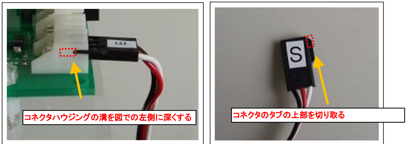
図 1-8 シャーシ基板ケーブル接続イメージ(オリジナルコネクタ接続)
