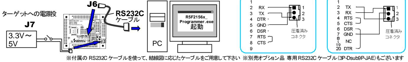
※付属のRS232Cケーブルを使って、結線図に応じたケーブルをご用意して下さい ※別売オプション品 専用RS232Cケーブル(3P-Dsub9P/JAE)もございます
