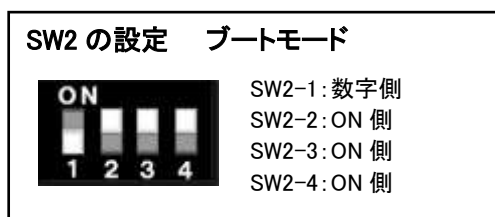
図 3-3 SW2 ジャンパ設定図2
