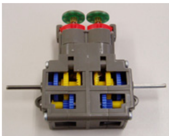
写真 3-4 ギヤボックスを組み立て、トルクチューンモーターPRO を取り付けた状態
