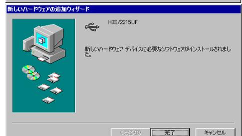
ウィザードが自動起動しない場合、接続状態でコントロールパネルのハードウェアの追加を起動し、検出する方法もあります。
