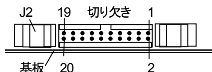
J2 FLASH インタフェースコネクタ ピン配置と切り欠き位置
