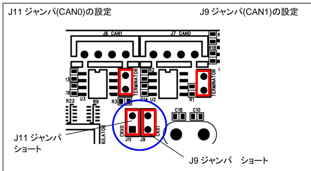
図 2-4 CAN0・1 接続ジャンパ設定図
