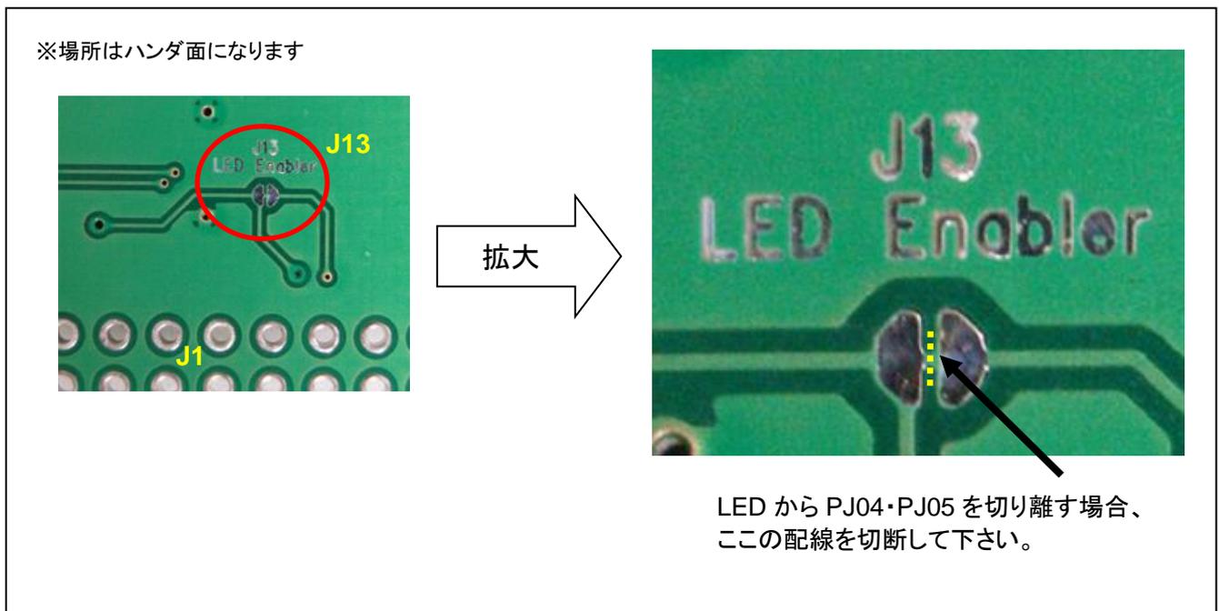
図 2-5 J13 切断箇所拡大図
