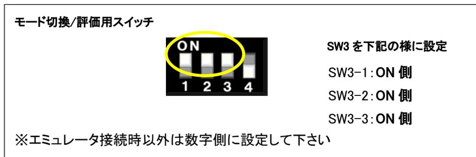
**図 2-2 モード切換/評価用スイッチ(SW3)設定図**
