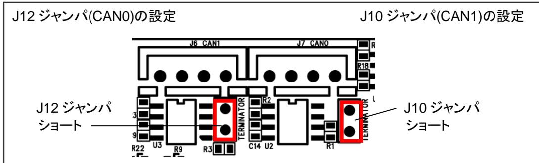
図 2-3 CAN0・1 終端抵抗イネーブル制御ジャンパ設定図
