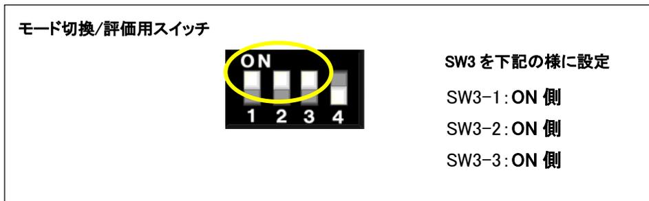
**図 2-2 モード切換/評価用スイッチ(SW3)設定図**
