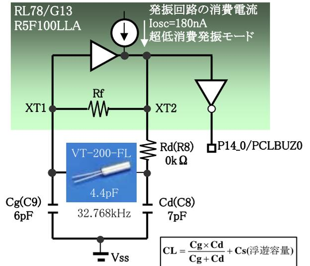
図2.評価回路図
