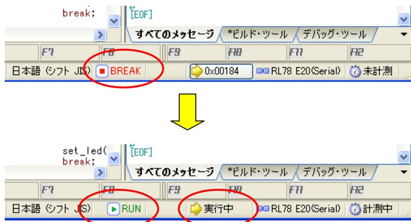
プログラムが実行中になったら、ボードのスイッチを押下し、LED の点灯確認が可能となります。
