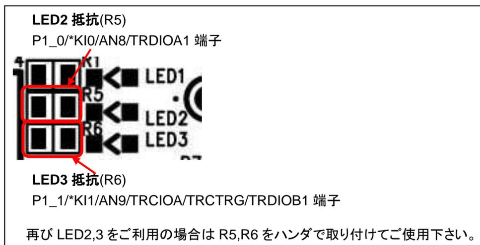
図 2-3 P1\_0,P1\_1 端子制御設定図(R5,R6)
