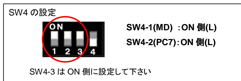
図 5-1 ブートモード(SCI ブート)動作時の SW4 の設定図
