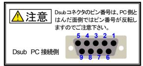
■CPUボード(HSB-R8C/M12)接続側(TTL) 結線図の「TO CPU」側の信号が、【表2】のピン番号の ピンに接続するように付属ライター//Fケーブルを配線し 加工して下さい。
