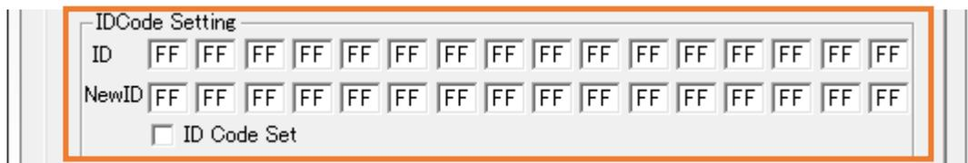
現在マイコンに設定されている、IDコード(16 バイト)を ID のボックスに入力してください。マイコンチップの出荷時は、ID 未設定です。
