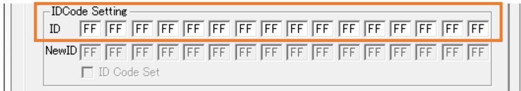
現在マイコンに設定されている、IDコード(16 バイト)を ID のボックスに入力してください。マイコンチップの出荷時の設定は、RX26T, RX64M, RX660, RX66T, RX71M, RX72T, RA, RA/TZ(NO\_DLM), RE, RISC-V:ID 未設定、RX65, RX66N, RX671, RX72M, RX72N:0xFF×16 となっています。ID 未設定のチップの場合、任意の値を設定しても問題ありませんが、「FF」のままとする事を推奨致します。
