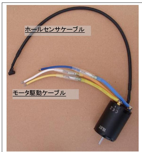
ブラシレスモータに、モータ駆動ケーブルの先端の被覆を剥き、
