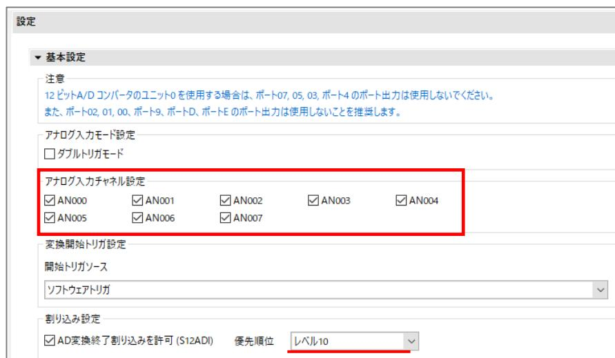
使用している端子(全て)にチェックを入れ、A/D 変換終了割り込みを有効化します。(ここでは、レベル 10 に設定しています。)
