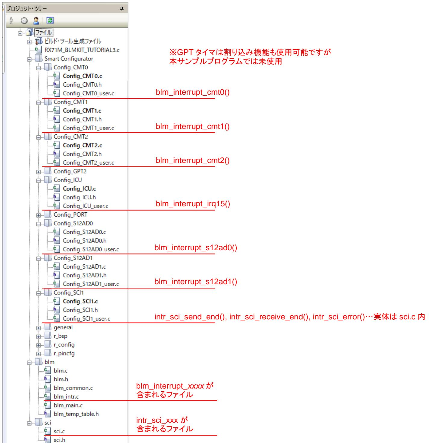
A/D 変換とコンペアマッチタイマの割り込みコールバック関数(\_user.c に含まれる)内に、割り込み処理を記載した関数呼び出し(blm\_interrupt\_xxx()関数)を記載しています。割り込み関数本体は、blm\_intr.c 内にまとめています(SCI の割り込みを除く)。
