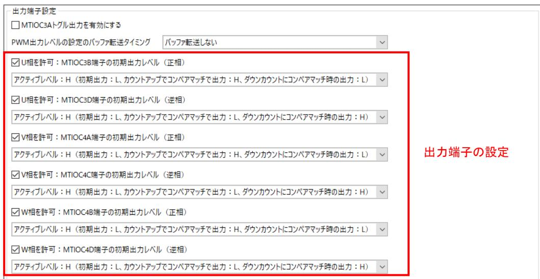
出力端子設定は、チュートリアル A 同様「アクティブレベル:H」です。(モータドライバボードの仕様で決まる部分なので、本チュートリアルでも変わらない)
