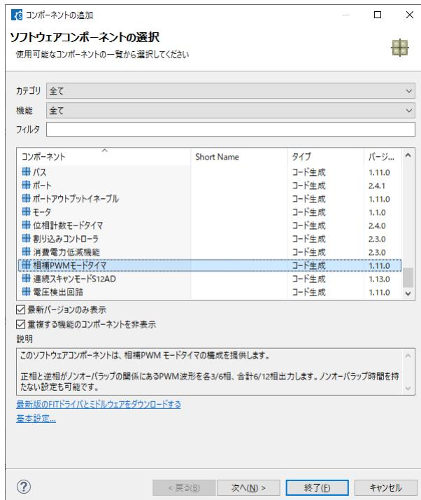
スマート・コンフィグレータでは、相補 PWM タイマを選択します。
