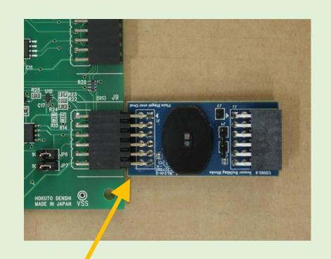
コネクタをボードに挿すだけで、電源供給も信号 接続も完了
