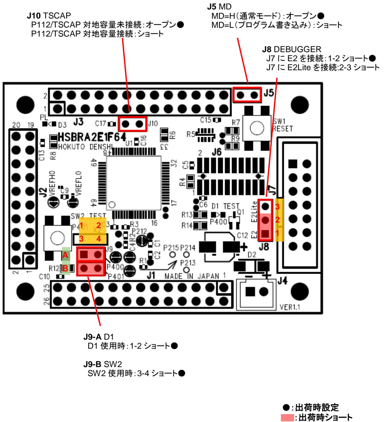
図 1-2 ボード配置図(ジャンパ)
