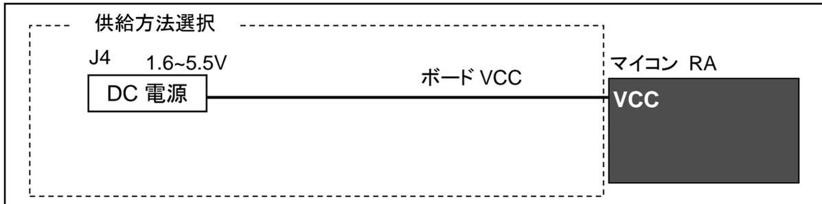
図 2-2 電源供給方法イメージ図
