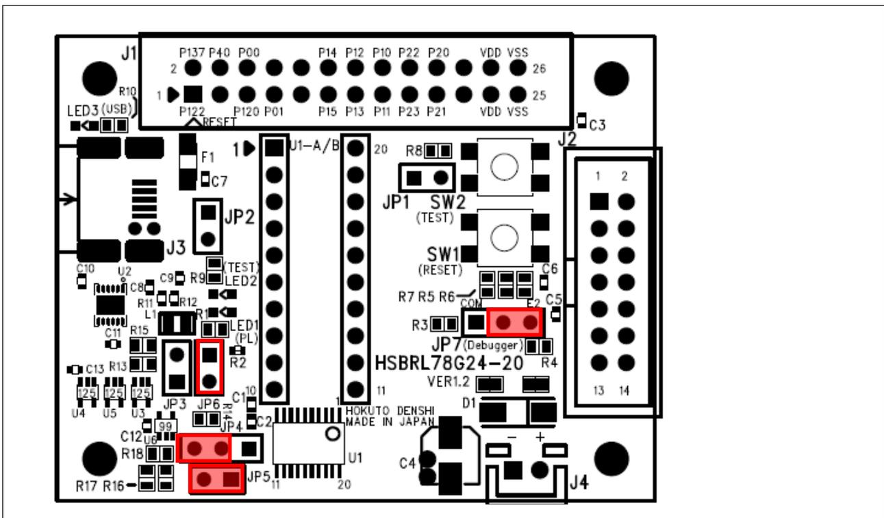
図 2-3 USB-Serial 変換回路の使用時のジャンパ設定
