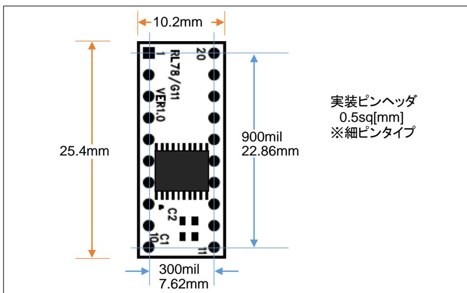
図 3-2 ボード寸法図(DIP パッケージ変換ボード)
