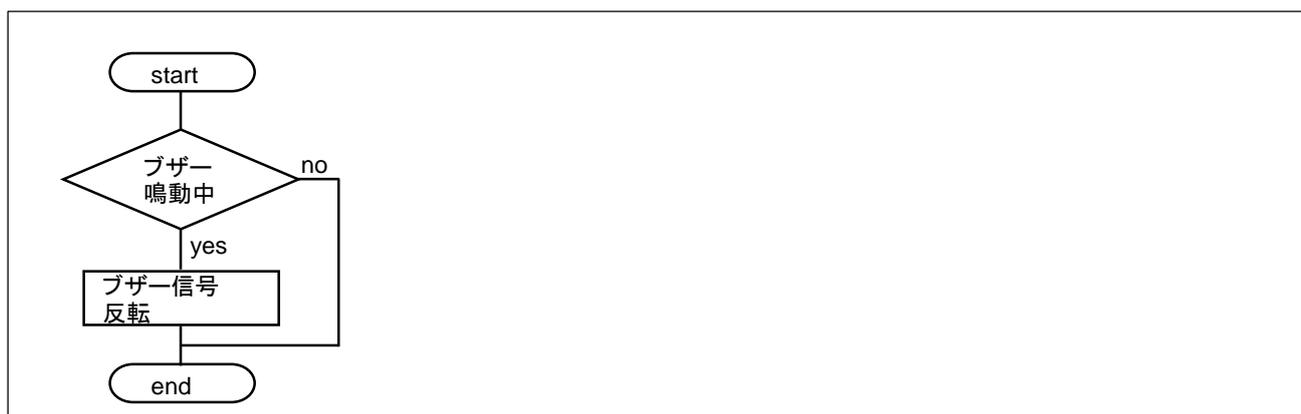
ブザーを 4kHz で鳴動させるための、周期割り込み。
