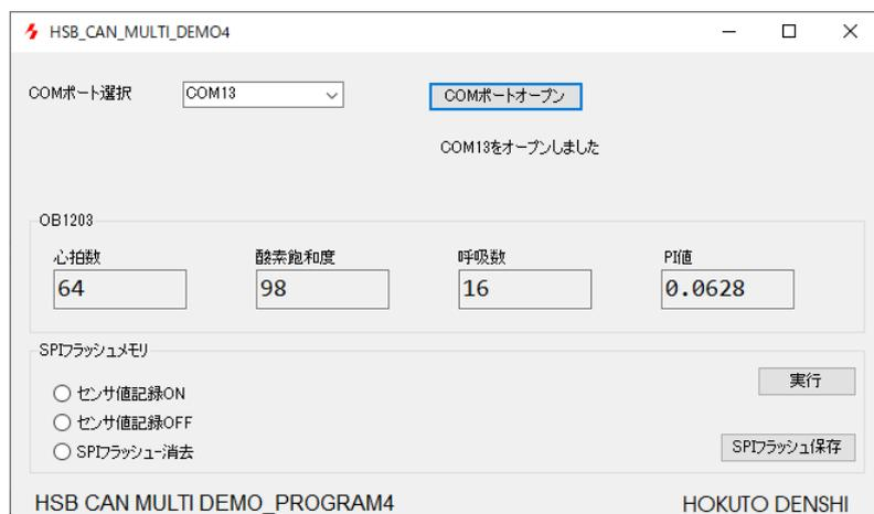
本アプリケーションは、1 系統のセンサデータしか扱いませんので、250ms 毎に、スレーブアドレス 0x53 (US082-OB1203EVZ のスレーブアドレス) のデータを送るように要求します。
