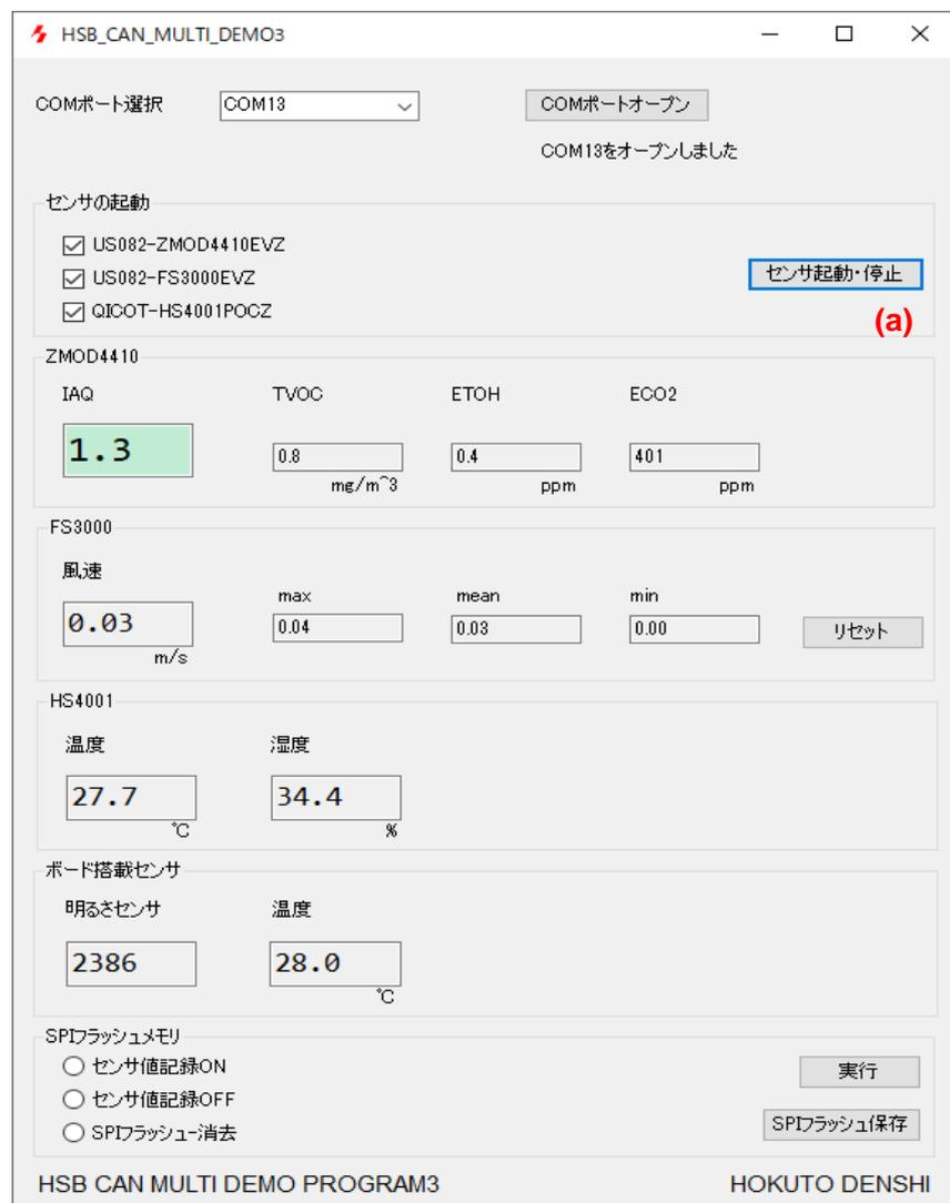
(a)CAN バスにセンサの起動・停止を指示するパケットの送信
