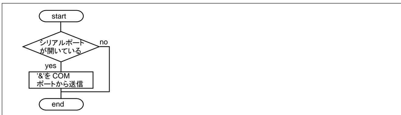
HSB\_CAN\_MULTI\_4 側では、&(データ取得コマンド)に应答して、データを送信しますので、PC 側のアプリケーションでは定期的(500ms に 1 回)、'&'を COM ポートから送信します。
