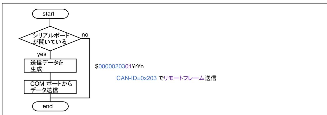
10ms タイマは、HSB\_CAN\_MULTI\_3 ボードに対して、リモートフレームを送信します。(HSB\_CAN\_MULTI\_3 ボードは、リモートフレームを受け取ると、現時点のモードが SPI フラッシュのリードになっているので、SPI フラッシュのデータを返送します。)
