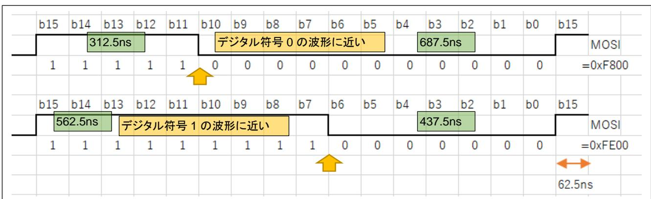
図 1-5 SPI を使用した制御波形出力イメージ
